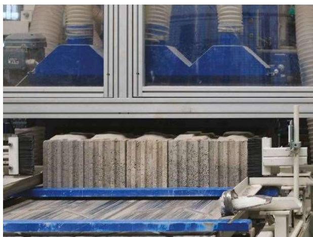
Entrée des blocs moussés dans la rectifieuse
