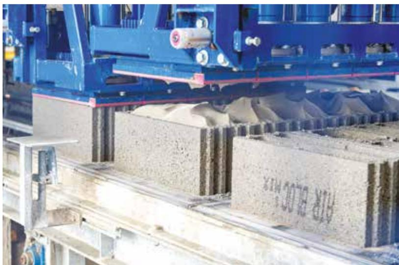
Tout juste fabriquée, la mousse minérale isolante est injectée dans les alvéoles des blocs béton.
